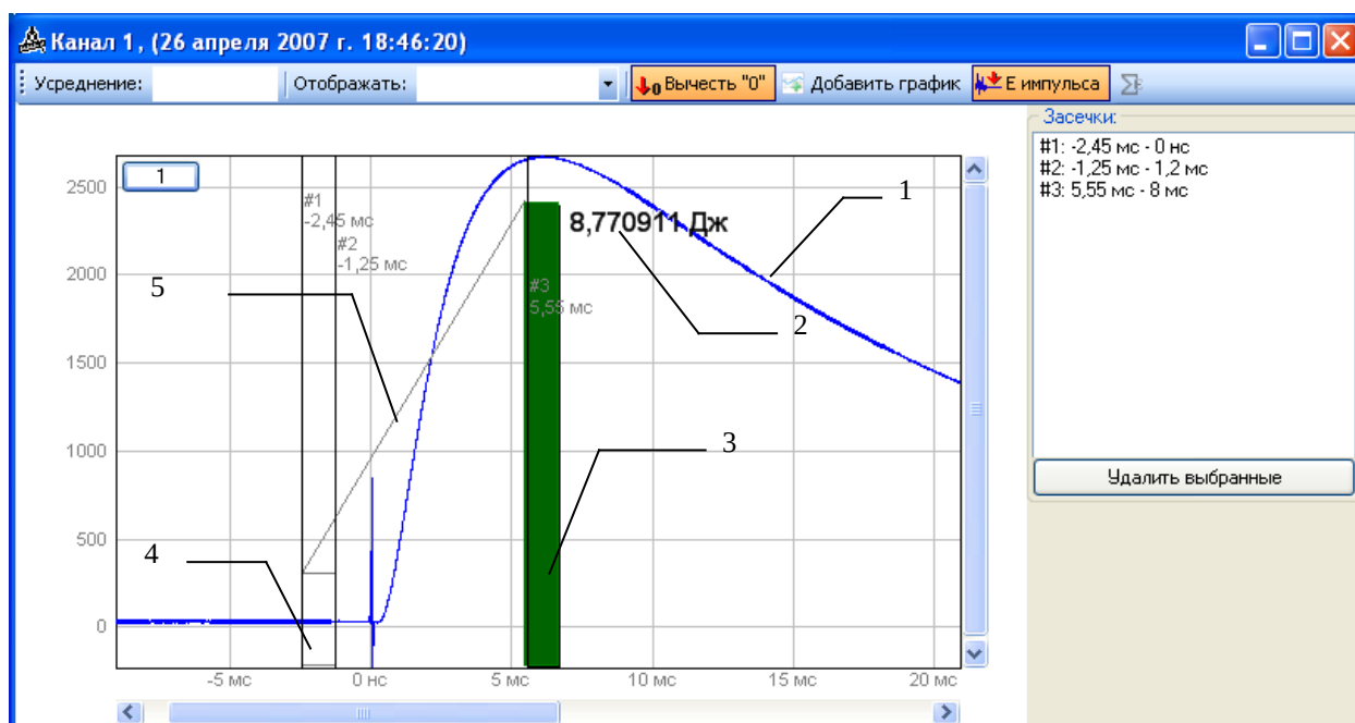
Рис.8.7. Временное окно с определением энергии импульса «по перепаду».
